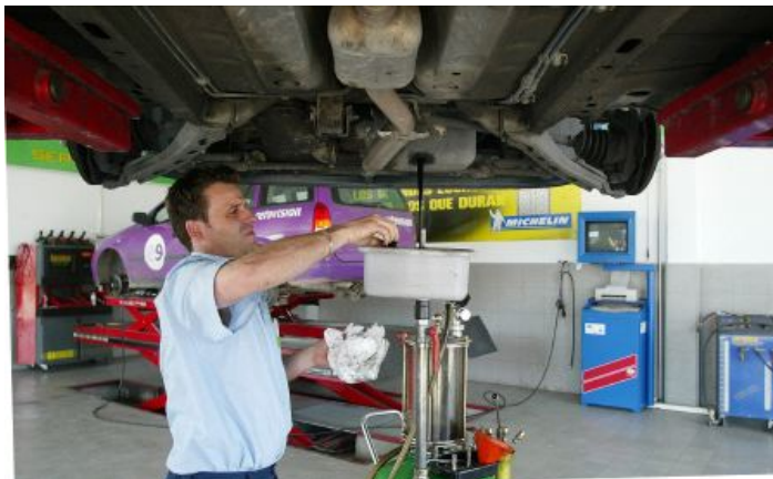
Foto N° 1 Drenaje adecuado de aceite lubricante usado (Fuente: www.laverdad.es )
