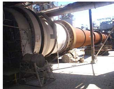
Foto N° 2 Horno rotatorio para obtener clinker ( www.machineryandequipment.com )
