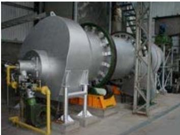
Foto N° 4 Incinerador rotatorio
